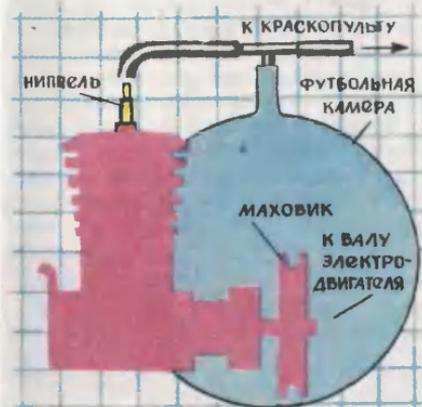
тель будет работать в режиме компрессора. Сжатый воздух подается в пульверизатор для распыления краски.
